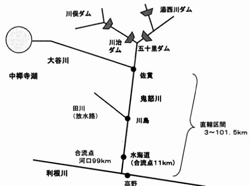
図5 鬼怒川・ダム模式図 筆者作成
